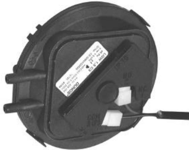
Le pressostat air est un organe de sécurité qui permet le contrôle du fonctionnement de la ventilation. Sa valeur de déclenchement peut être réglée entre 1 et 10 mbar.
